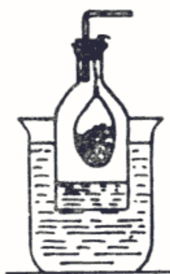
Fig. 26 — Generator de gaze.
